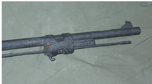
Charakteristisch ist der Haken unter dem Oberring
