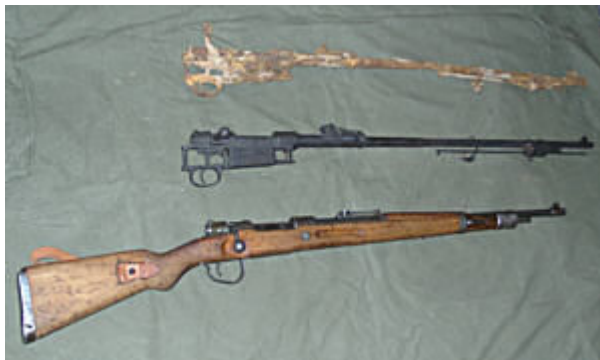
Der Vergleich mit dem Karabiner 98k der Wehrmacht (unten) zeigt dass der Lauf des "Gewehrs 98" ca. 13 cm länger war. Weiteres Charakteristikum ist der gerade Kammerstengel, der beim 98k abgebogen war.
